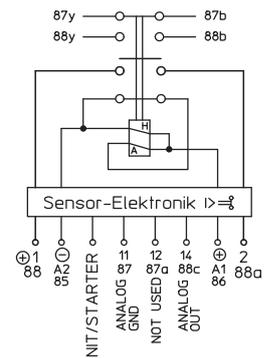
Die Elektronik des Relais misst den Hauptstrom galvanisch getrennt. Beim Überschreiten der von ihnen vorgegebenen Stromschwellen schaltet das Relais ab und bleibt bis zum Zurücksetzen des INIT-Eingangs oder der Versorgungsspannung abgeschaltet. Bei erneutem Einschalten wird das Relais wieder aktiviert.
