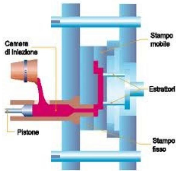
*Pressofusione e forgiatura a caldo sono i processi maggiormente usati per fabbricare terminali batteria.*
